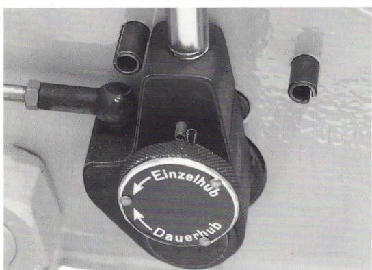
Bild 11.2: Spannstift als Anschlagstift
